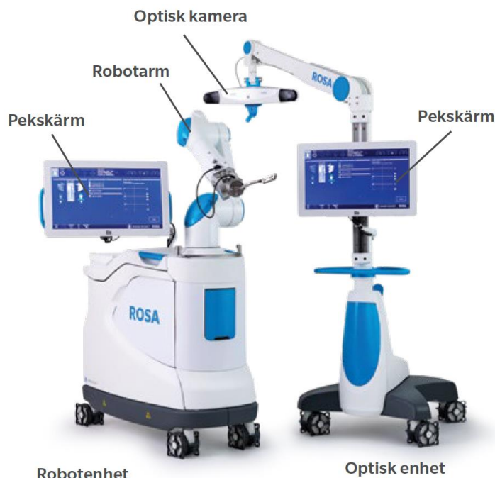
Figur 1 Huvudkomponenter i ROSA knäsystem enligt bruksanvisning
